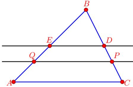
Note que los triángulos  $ABC$ ,  $QBP$  y  $EBD$  son semejantes. Además, la razón de semejanza entre los triángulos  $ABC$  y  $EBD$  está dada por  $\frac{BC}{BD} = 2$ , pues  $D$  es el punto medio de  $\overline{BC}$ ; de modo que la razón entre las áreas de estos triángulos<sup>2</sup> es  $\frac{a(ABC)}{a(EBD)} = 4$ .
