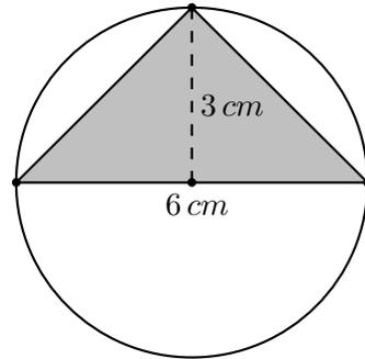
Así, el área de dicho triángulo es  $\frac{6\text{ cm} \times 3\text{ cm}}{2} = 9\text{ cm}^2$ .
