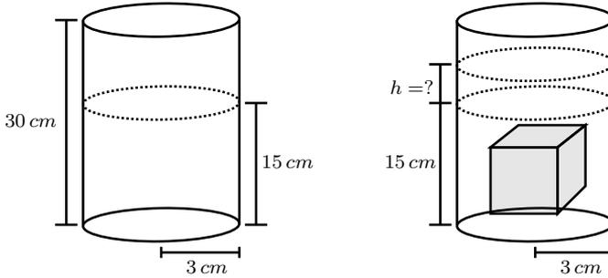
Al introducir un cubo macizo de 3 cm de arista, el cual tiene un volumen de  $27 \text{ cm}^3$ , el nivel del agua aumenta  $h \text{ cm}$  como se muestra en la figura. Observe que el volumen aumentado dentro del cilindro está dado por  $\pi \times (3)^2 \times h = 27 \text{ cm}^3$ , de donde  $h = \frac{3}{\pi} \text{ cm}$ .
