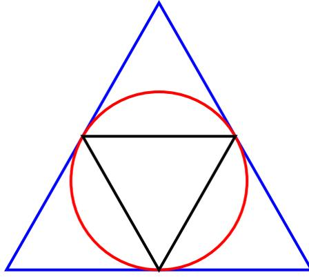
Note que el triángulo exterior de área  $A$  queda dividido en cuatro triángulos pequeños iguales, siendo uno de ellos el triángulo interior a la circunferencia de área  $B$ , por lo tanto  $\frac{B}{A} = \frac{1}{4}$ .
