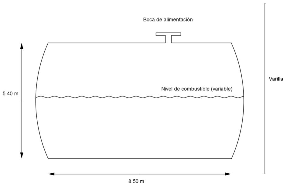
*Figura 3.* Corte transversal del tanque.
